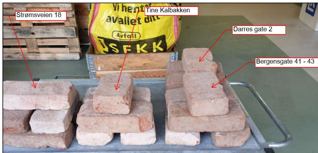
Tegl fra fire ulike bygg. Foto: Øst-Riv
