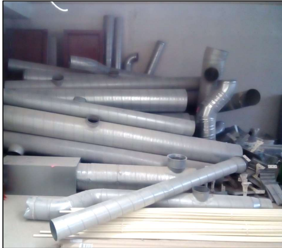
Brukte, runde ventilasjonskanaler og kanalbend - demontert og grovsortert i KA13. Foto: Anne S Nordby
