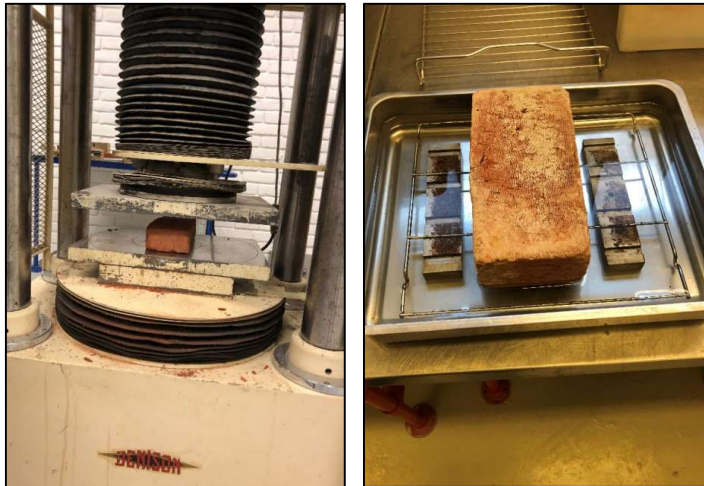
Testing hos Sintef i Oslo; hhv. trykkprøving og minuttsg. Foto: Sintef
