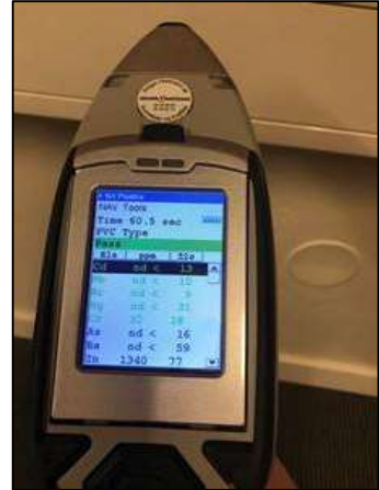
Veggkanaler i plast i KA23 og XRF-måling. Foto: Jennifer Lamson
