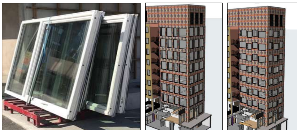
Vinduer demontert fra et boligprosjekt i Kværnerbyen. Foto: Resirqel Fasade tilbygg, prosjektert med 1) Nye vinduer, 2) Brukte vinduer. Illustrasjoner: Mad arkitekter
